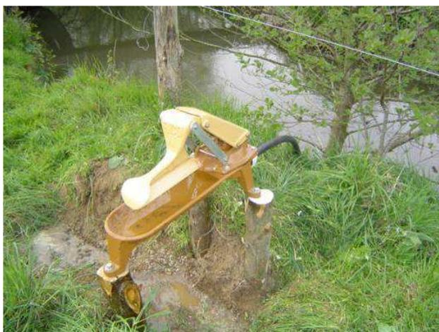
Installation avec vissage sur 3 piquets en châtaignier
